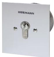
**Contactador de llave ESU 30** con 3 llaves, versión empotrada, función impulso o Abrir / Cerrar a elección; Medidas de la caja de enchufe: 60 mm (d), 58 mm (Fo), Medidas de la tarja: 90 x 100 mm (An x Al), Receso en la mampostería: 65 mm (d), 60 mm (Fo); Índice de protección: IP 54
