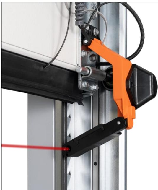
**SEGURIDAD SIN CONTACTO.** Un control eficiente del canto de cierre incrementa la seguridad. Equipamos los automatismos WA 500, WA 500 FU e ITO 500 FU opcionalmente con la célula fotoeléctrica antepuesta VL1-LE sin incremento de precio. que reacciona sin contacto a los movimientos y obstáculos y detiene la puerta de forma segura si es necesario.
